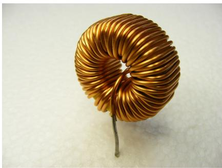
Une bobine torique - Un fil isolé est enroulé autour d'un noyau de ferrite
